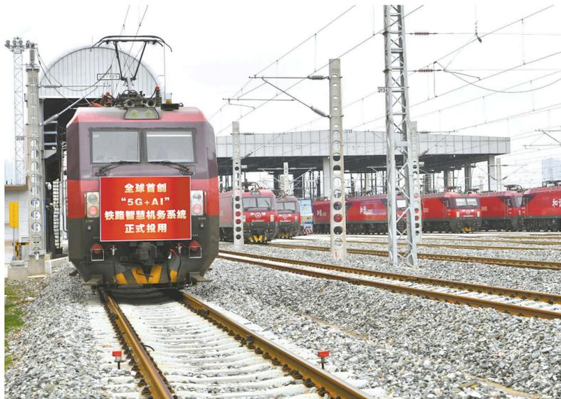
9月4日14时46分，首台搭载5G设备的402号“和谐HXD3D”型大功率电力机车驶入西安机务段机车整备场。不到90秒的时间，15.6GB的机车视频数据自动转储完成，标志着“5G+AI”智慧机务系统正式投用。这是在全球范围内首次在铁路机车上应用5G技术。5G车地高速转储和人工智能(AI)分析解决方案采用全新毫米波频段、多天线、波束赋形等5G先进技术，较之前转储效率提升了13倍，且全程无需人工干预。转储后的数据融入数据服务平台，系统结合大数据和AI技术，智能分析、自动识别问题和故障，大大提升分析效率。视觉中国供图
